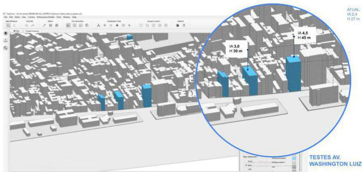
Figura 48. Teste volumétricos para lotes na Av. Washington Luiz com variação de IA entre 3 e 4,5
