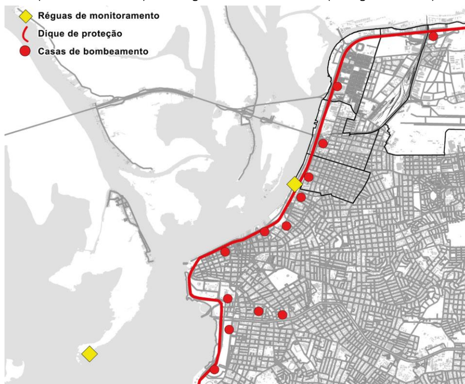
Figura 96. Localização em Porto Alegre do dique de proteção (linha vermelha), das casas de bombeamento (círculos vermelhos) e das réguas de monitoramento (losangos amarelos).
