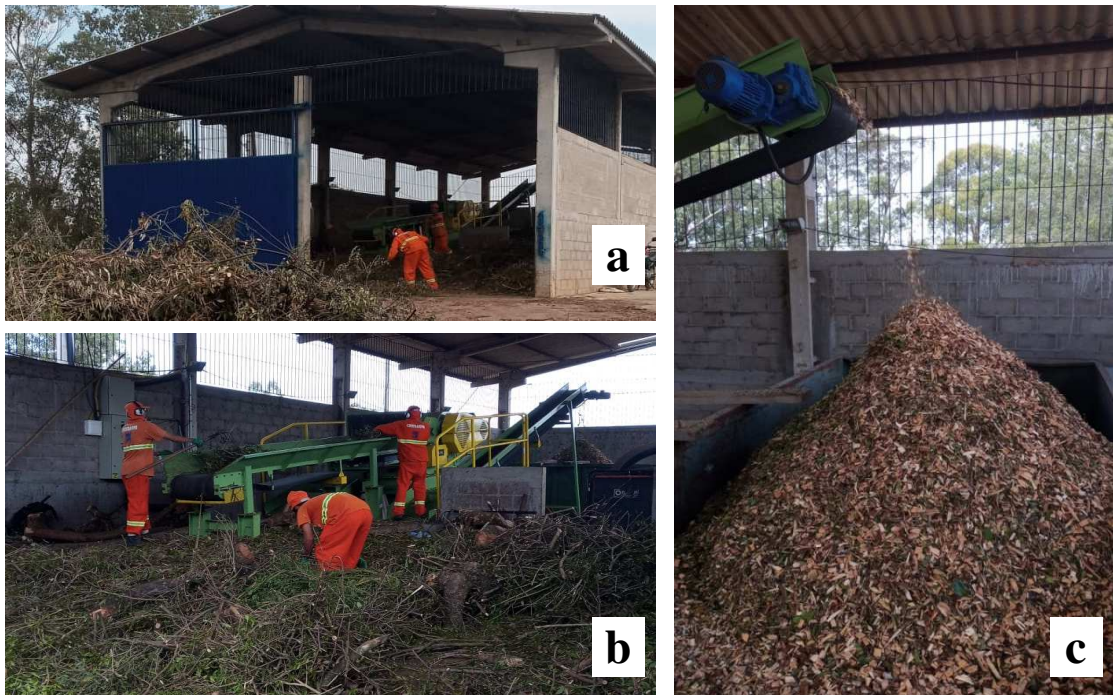
Figura 4.26 – Unidade de trituração de arbóreos: (a) recebimento, (b) trituração de galhos e (c) material triturado pronto para compostagem
