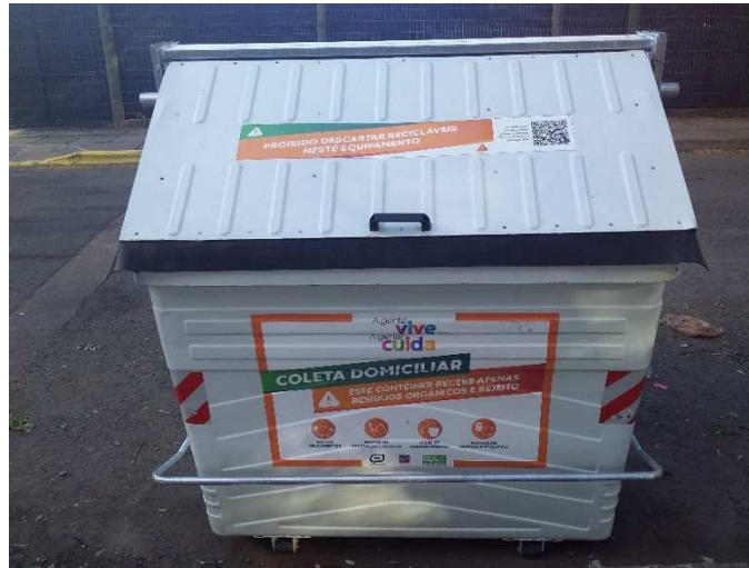
Figura 4.6 – Acondicionamento e apresentação de resíduos à coleta em contêineres (resíduo domiciliar - coleta automatizada)
