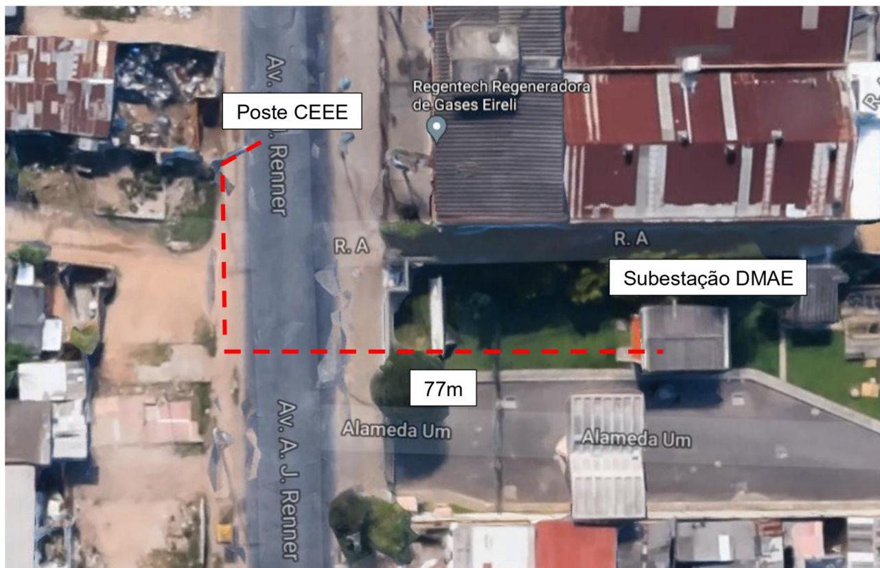
Foto 1. Percurso dos cabos
