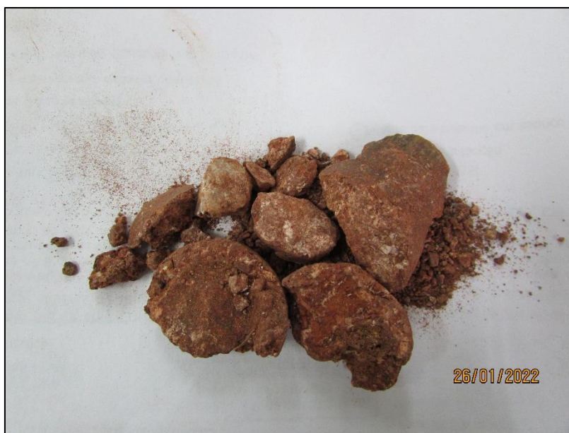
Figura 23. Argila arenosa, formada por alteração de rocha granítica.
