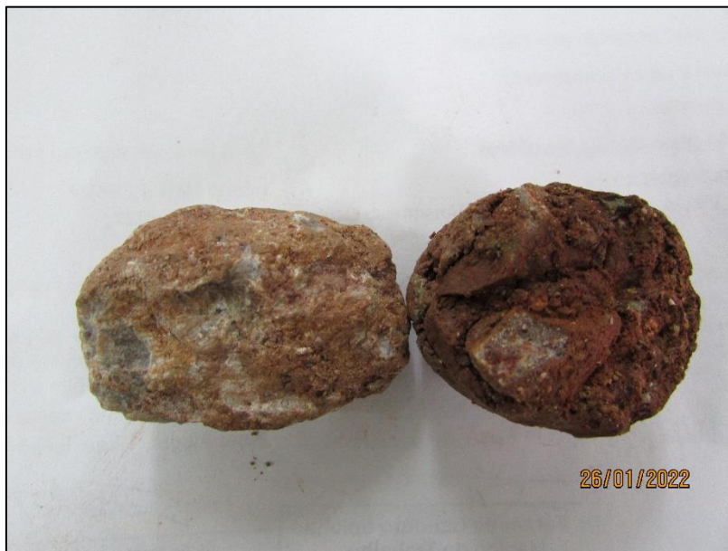
Figura 25. Porções de rocha alterada misturada com solo argiloso, devido a movimentação prévia do solo.
