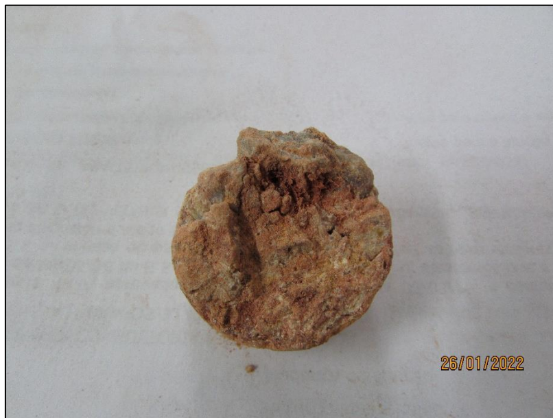
Figura 24. Rocha granítica alterada, próxima ao final da sondagem.
