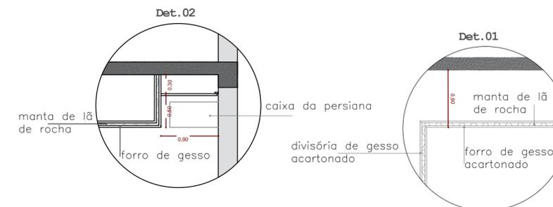
forro sobre divisória de gesso acartonado com isolamento acústico
