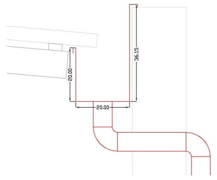
5.4.4.3 No canto sudoeste, no sentido longitudinal das telhas onde encontram a alvenaria, deverá ser instalado rufo lateral (corte 33) no comprimento de aproximadamente 1,60m.
