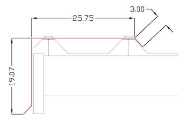
5.4.2 <u>Face sul:</u> Instalar chapa galvanizada (corte 50) no acabamento longitudinal lateral por baixo das telhas conforme croqui abaixo.
