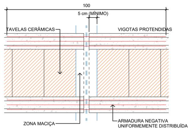
**DISPOSIÇÃO DAS VIGOTAS SOBRE VIGAS METÁLICAS**
