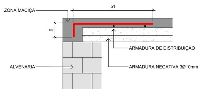
**DETALHE APOIO VIGOTAS EM ALVENARIAS**
