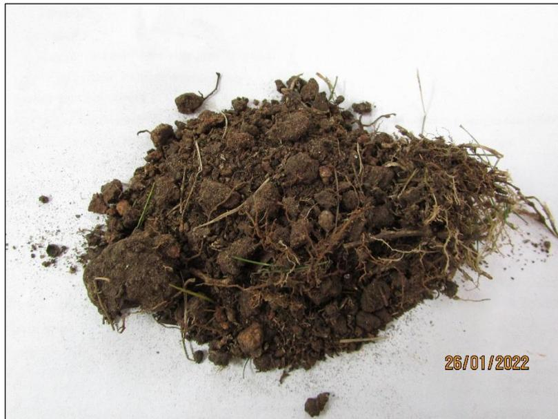
**Figura 22. Solo orgânico na porção superior da sondagem.**
