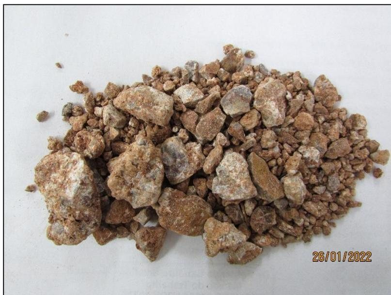
**Figura 26. Rocha granítica alterada, próxima ao final da sondagem.**
