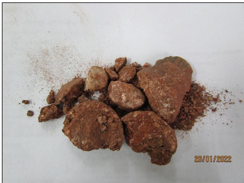
**Figura 23. Argila arenosa, formada por alteração de rocha granítica.**
