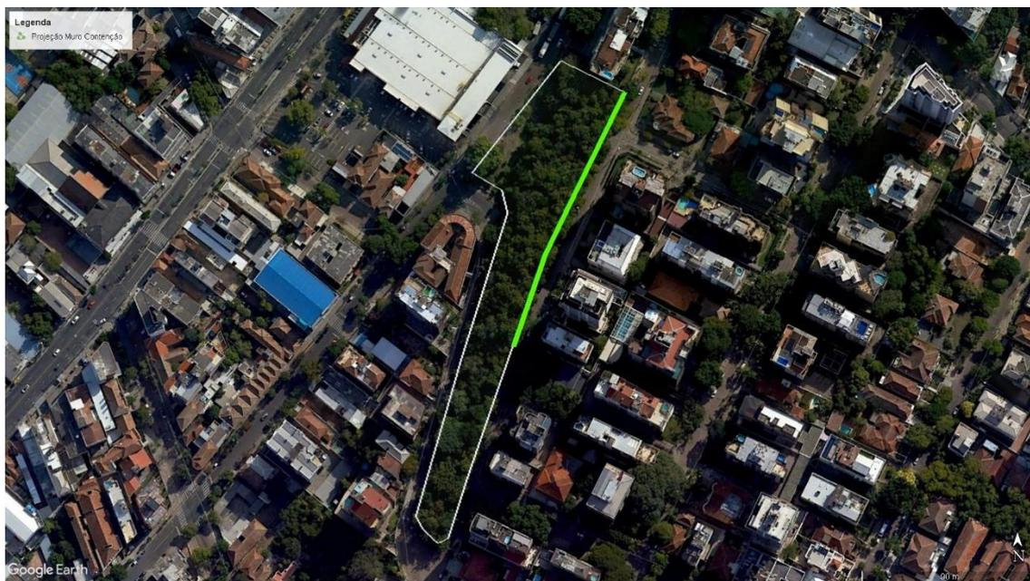
**Figura 21. Projeção do trecho em que deve ser instalado um muro de contenção (linha amarela na imagem) para amenizar o problema de perda de partículas de solo. Fonte: levantamento de campo sobre imagem do software Google Earth.**
