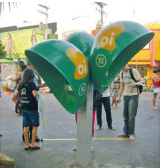
Foto 04 – Telefone público sem piso tátil de alerta
