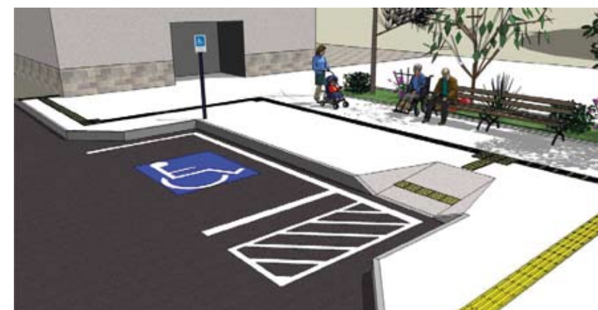
Figura 66 – Vaga reservada para pessoa com deficiência
